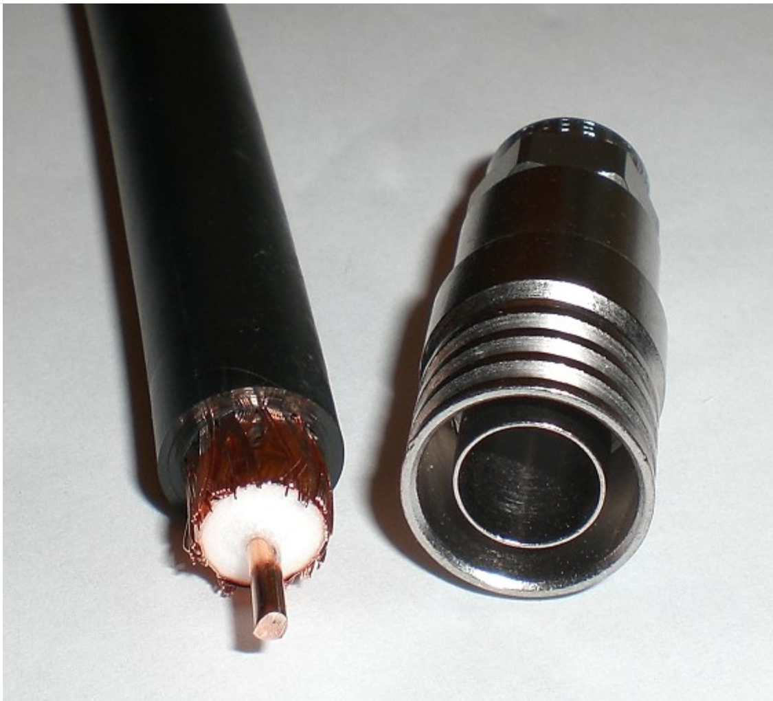
11PRtC dénudé (mêmes longueurs d'âme et de tresse dénudées).
